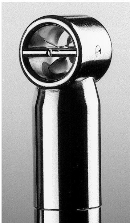
T-Sonde sehr geringer Baugröße, 16 mm lang, Schaft Ø 8 mm, ±Strömungsrichtung erkennend
