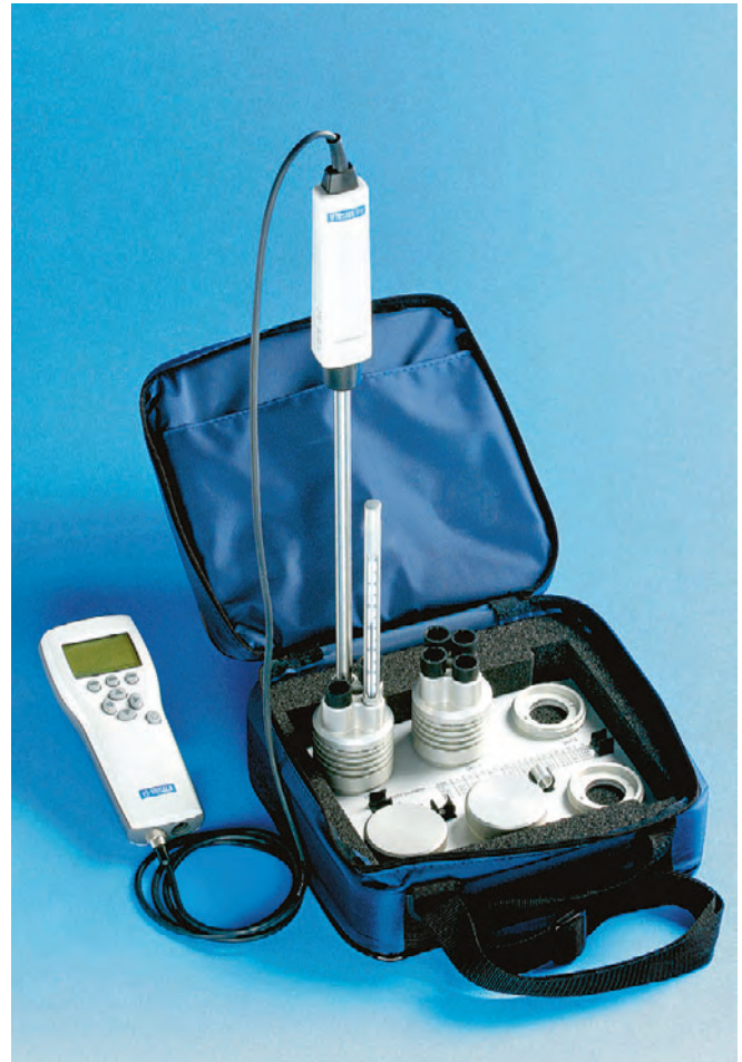
Beispiel für die Kalibrierung eines Vaisala HUMICAP® Feuchte- und Temperatur-Handmessgerätes HM70 durch den HMK15 in seiner Transporttasche
