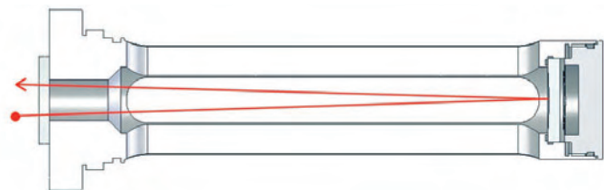
Strahlengang in der Sonde des Vaisala SPECTRACAP® Sensors
