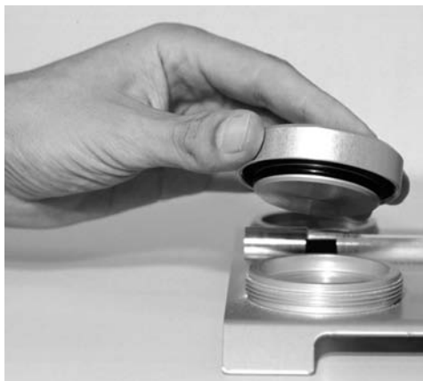
Abb 2.1 Den Transportdeckel auf die Grundplatte drücken
