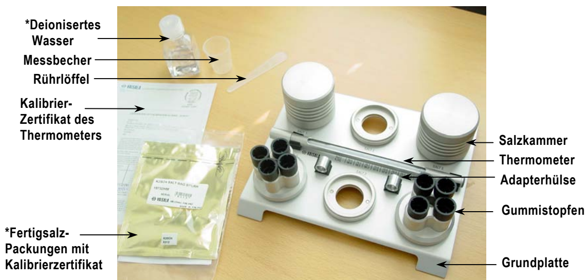
Abb 1.1 Der Kalibrator HMK15 und einige Zubehörteile*
