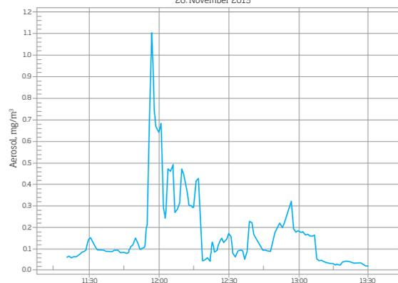
**Zeitlicher Verlauf** – die graphische Darstellung der Daten bietet den Überblick des Messverlaufs, ein Vorteil welchen die Gravimetrie nicht bieten kann. Die Echtzeitdaten in diesem Beispiel verdeutlichen die Bedeutung der Erkennung von Expositionsspitzen. Der Arbeitsschützer erkennt Anhand dieser Daten, gefährliche Spitzen und kann unverzüglich Maßnahmen empfehlen.
