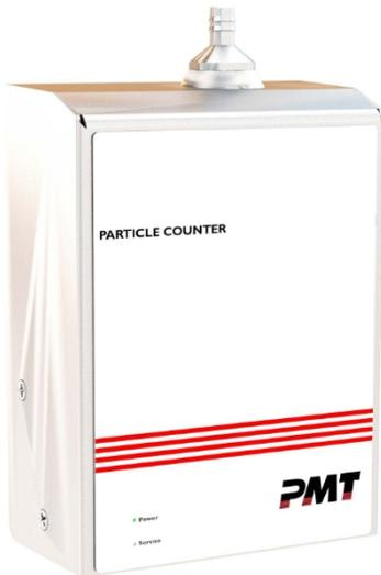
Die Partikelzähler 9301 und 9501 PoE messen in einem Bereich von 0,3 bis 25,0  $\mu\text{m}$  bei einer Durchflussrate von 0,1 CFM (2,83 LPM). Diese Partikelzähler ermöglichen eine effiziente Partikelzählung mit Spezifikationen, die die Kalibrierstandards ISO 21501-4 und JIS B9921 erfüllen.
