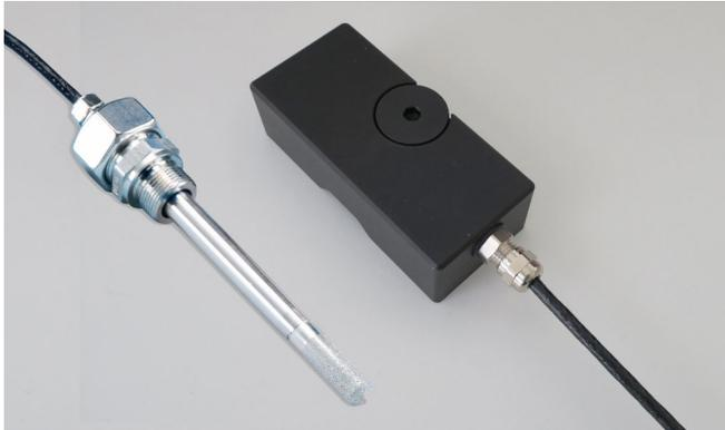
Die Sonde HMP374 kann direkt in Hochdruck-Rohrleitungen oder Unterdruckkammern installiert werden.
