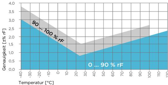
Genauigkeit der HMP3 Feuchtemessung in Abhängigkeit von der Temperatur
