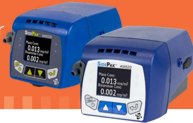
**Die SidePak™ AM520 und AM520i personengetragenen Aerosolmonitore sind kleine, tragbare, batteriebetriebene lichtstreuende Laserphotometer inkl. Datenaufzeichnungsfunktion, die in Echtzeit die Aerosolmassenkonzentration von Stäuben, Dämpfen, Rauch und Nebel im Atembereich einer Person messen.**
