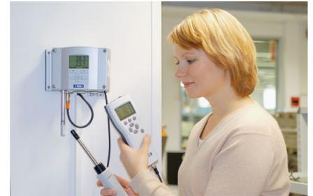
Das portable Feuchte- und Temperaturmessgerät HM70 ist die ideale Lösung zum Prüfen von HMT330-Messwertgebern.
