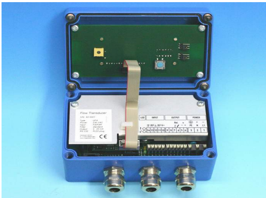
Abb. 2: Anschluss LCD-Anzeige bei geöffnetem Gehäusedeckel
