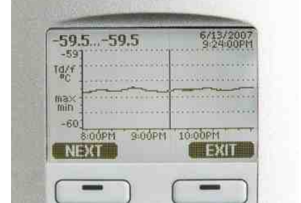
Darstellung des Messwertverlaufs in Echtzeit sowie der gespeicherten Historie auf dem Display
