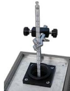
Kalibrierbad: Aluminium, Volumen ca. 400 cm<sup>3</sup>, homogene Temperatur durch Magnet-Mixer, regelbar. Gehäuse: Metall; Abmessung: 160 x 340 x 330 mm; Gewicht: ca. 8 kg. Hinweis: die Genauigkeitsangaben beziehen sich auf Umgebungstemperatur +23°C und werden für 1 Jahr zugesichert. Inkl. RS232-Schnittstelle und Anschluss für Schalter-Test.
