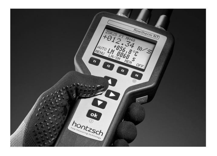
Multifunktionales Handgerät mit Datenlogger zum Messen von Durchfluss, Strömungsgeschwindigkeit, Temperatur, Druck und anderen Messgrößen
