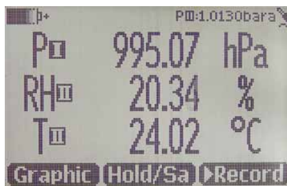
Einige Feuchtemessgeräte ermöglichen die Wahl eines einzelnen Feuchtwertes, der dann in einem grafischen Display dargestellt werden kann. Die Abb. zeigt verschiedene Ansichten des Displays des portablen Vaisala HUMICAP® Feuchte- und Temperaturmessgeräts HM70.
