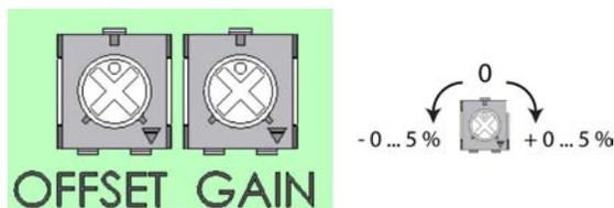
Abb. 4: Trimpotenzioometer für Offset und Gain
