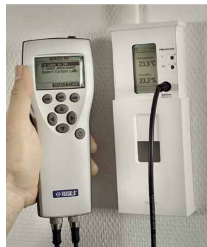
Vor-Ort-Kalibrierung eines Feuchtemesswertgebers HMW90 mit einem portablen Messgerät HM70.
