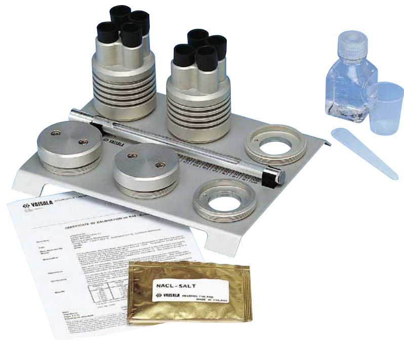
Der Vaisala Feuchtekalibrator HMK15 – Beispiel für ein Gerät mit gesättigten Salzbadern.
