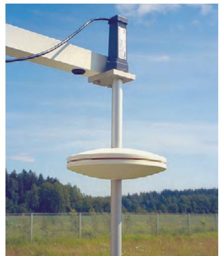
Ein PTB210 kombiniert mit dem Druckkopf SPH10 an einem Ausleger
