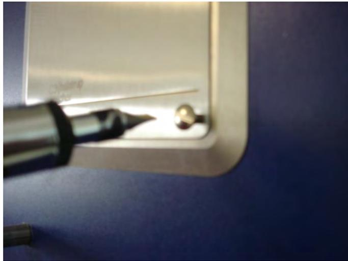
*Bild 11: Frontplatte festschrauben*
