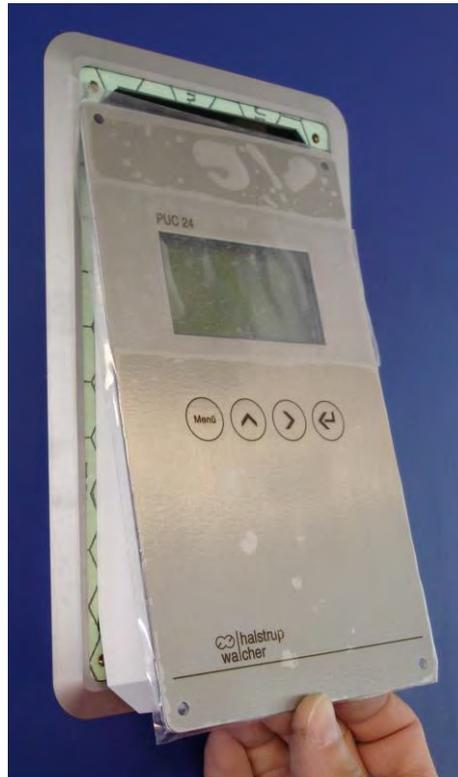
*Bild 9: PUC 24 schräg von unten ansetzen*
