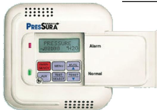
Die PresSura Raumdruck-Regelsysteme können sowohl den Raumdruck überwachen oder regeln als auch bei unsicheren Betriebszuständen warnen. Es werden sowohl Über- als auch Unterdruck sehr präzise gemessen. Einige Versionen dieser Systeme können durch eine RS-485 Schnittstelle mit dem Gebäudeautomationssystem kommunizieren und außerdem Volumenstrom und Luftwechselraten anzeigen. Alle Geräte sind mit Alarm-Relais und einem Analogausgang für den Raumüber- oder -unterdruck ausgestattet.
