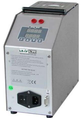
Die thermischen Teile der Kalibratoren, also die Kalibriertemperaturquelle, bestehen aus einem massiven Metallblock, der mit Peltierelementen geheizt bzw. abgekühlt wird. Im Metallblock sind eine oder mehrere Bohrungen zum Einführen der Prüflinge. Spezielle Einsatzhülsen bieten weitere Möglichkeiten, Prüflinge mit verschiedenen Durchmessern zu verarbeiten.
