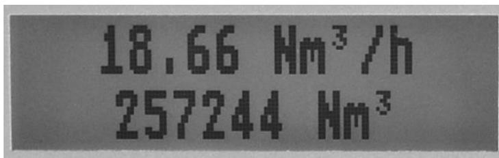
Zeile 1: Aktueller Volumenstrom/Massenstrom
