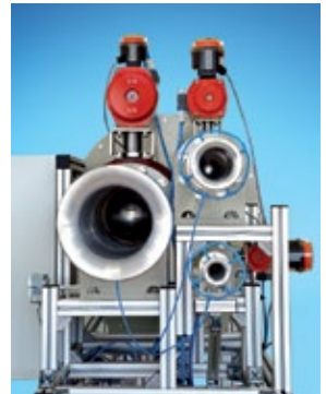
Einlaufdüsen des Prüfstands für Volumen- und Massenstrom
