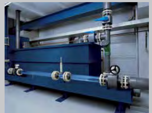
Wasser-Kalibrieranlage , Messbereich 0,5 ... 120 m 3 /h, Nennweiten bis DN 150
