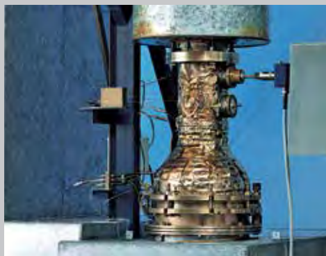
Hochtemperatur-Windkanal , +20 °C ... +400 °C, Messbereich 0,5 ... 70 m/s
