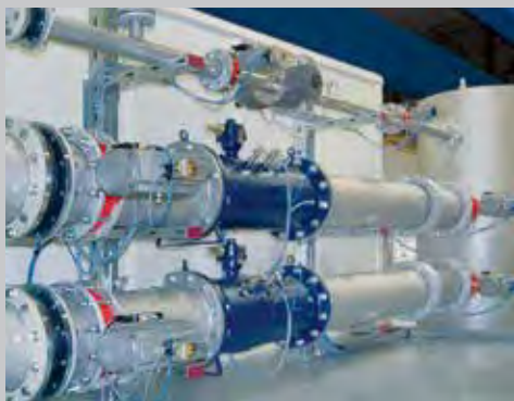
Atmosphärischer Volumenstrom-Prüfstand , Messbereich 5 ... 5500 m 3 /h
